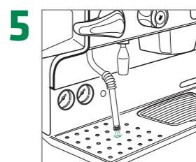
Sfogare la pressione della caldaia con la lancia vapore e controllare che la pressione della caldaia venga raggiunta di nuovo
