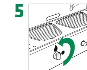
Premere il rubinetto del gas verso l'interno e ruotarlo per portarlo in posizione verticale
