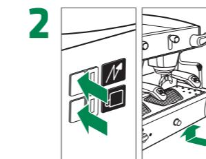
Spegnere lo scaldatzze, la resistenza caldaia e l'interruttore generale
