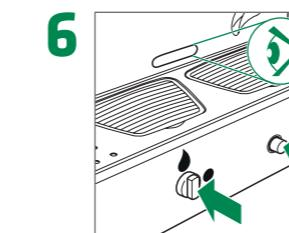
Tenere il rubinetto del gas premuto; attivare diverse volte il pulsante piezoelettrico fino a quando non si accende il bruciatore
